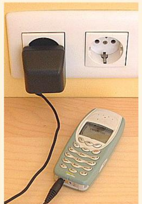
El cargador de un móvil utiliza diodos para transformar la corriente alterna de la red en corriente continua, necesaria para cargar las baterías.
