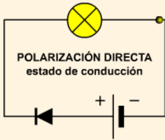
Polarización directa e inversa de un diodo en un circuito (arriba) y comparación de su funcionamiento con el de una válvula unidireccional (abajo)
