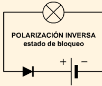
Polarización directa e inversa de un diodo en un circuito (arriba) y comparación de su funcionamiento con el de una válvula unidireccional (abajo)
